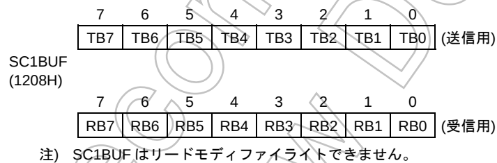
図 3.9.19 シリアル送受信バッファレジスタ (SIO1 用、SC1BUF)
