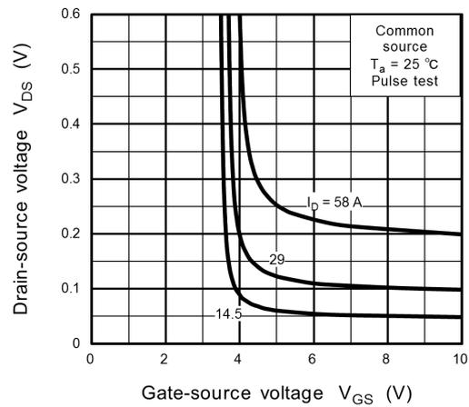
Fig. 8.4  $V_{DS} - V_{GS}$
