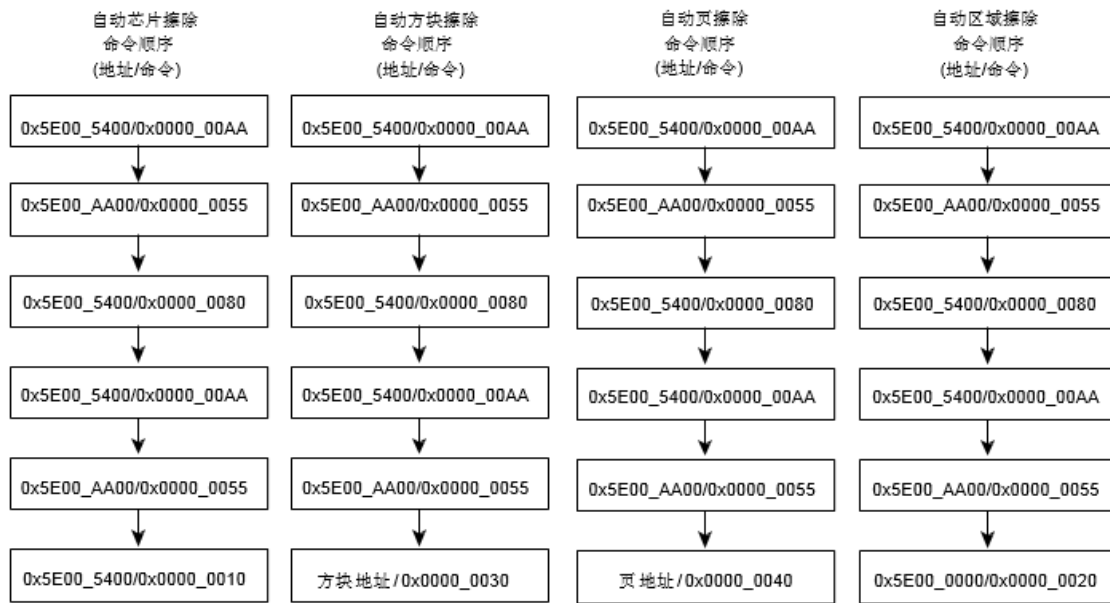
图 24-6 自动擦除流程图
