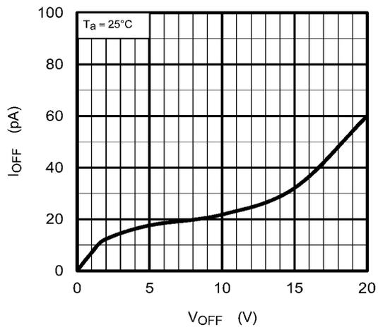
図 12.7 I<sub>OFF</sub> - V<sub>OFF</sub>
