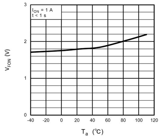
図 12.4  $V_{FON} - T_a$
