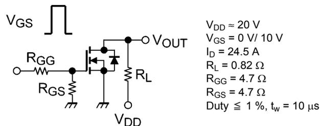
図 6.2.1 スwitchング時間の測定回路
