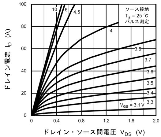
図 8.2  $I_D - V_{DS}$
