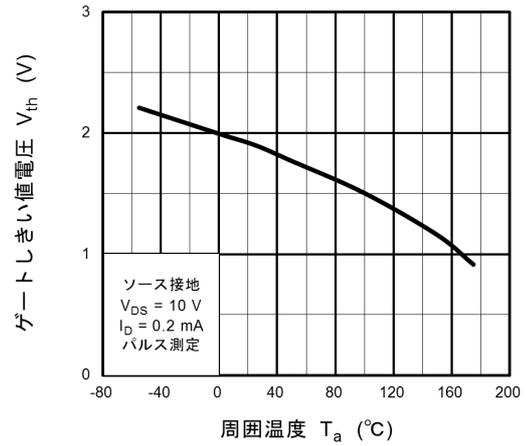
図 8.8  $V_{th} - T_a$
