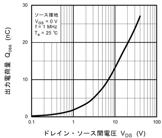
図 8.12  $Q_{oss} - V_{DS}$
