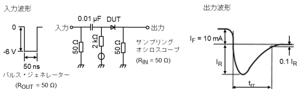
図 5.1 逆回復時間 ( $t_{rr}$ ) 測定回路
