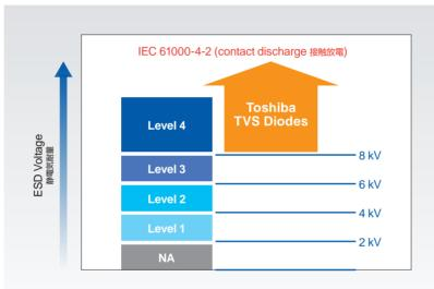
With ESD immunity of higher than 8 kV, Toshiba's TVS diodes meet the Level 4 requirements of IEC 61000-4-2 (contact discharge). 当社製品は静電気耐量8 kV以上の実力を有しており、IEC61000-4-2 (接触放電) 規格 Level 4を満たし
