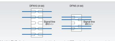
Multibit TVS diode arrays are suitable for use in USB and other buses consisting of multiple signal lines. The flow-through pinout simplifies board layout. USB など信号ラインを 複数持つセットには、マルチビットタイプが有効です。 フロースルーピン配置 を採用していますので、実装レイアウトが容易にできます。
