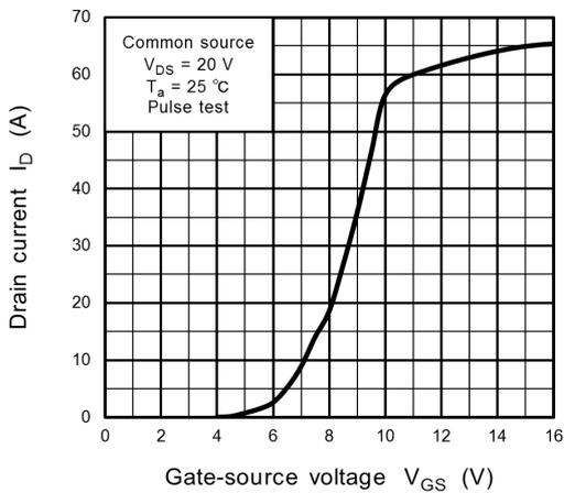
**Fig. 8.3  $I_D - V_{GS}$**
