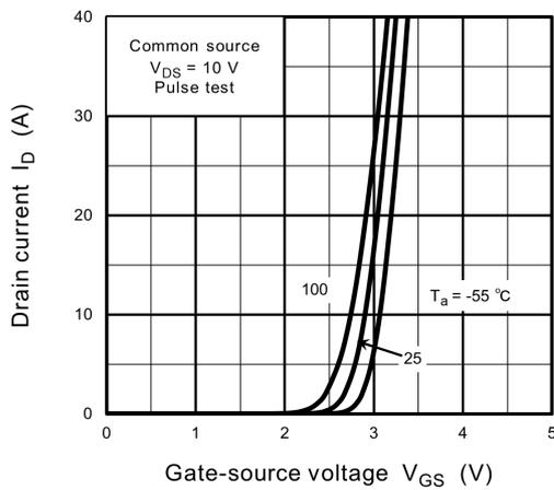
**Fig. 8.3  $I_D - V_{GS}$**
