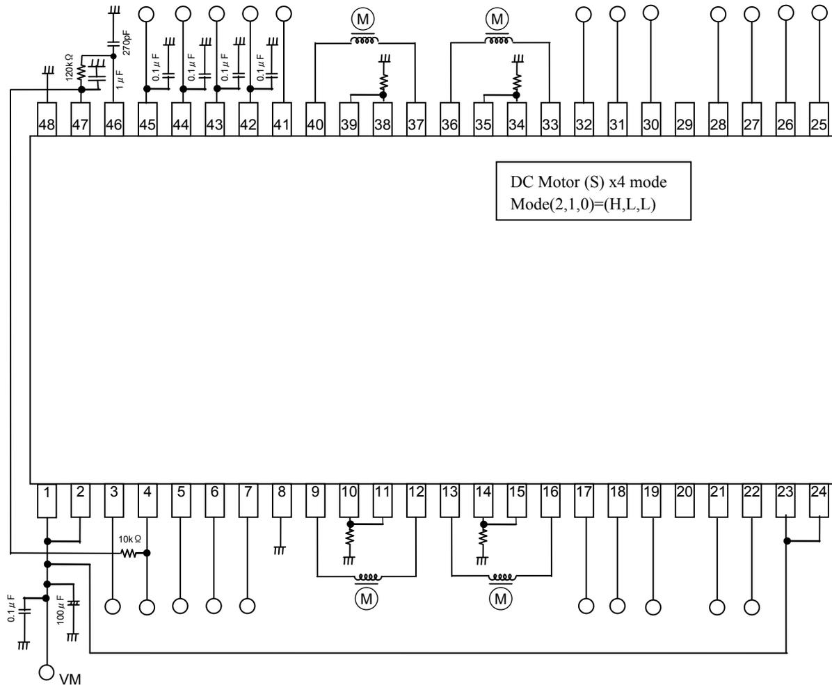
注: 必要に応じて、バイパスコンデンサの追加を推奨致します。GND配線は、できる限り1点接地になるようお願い致します。
