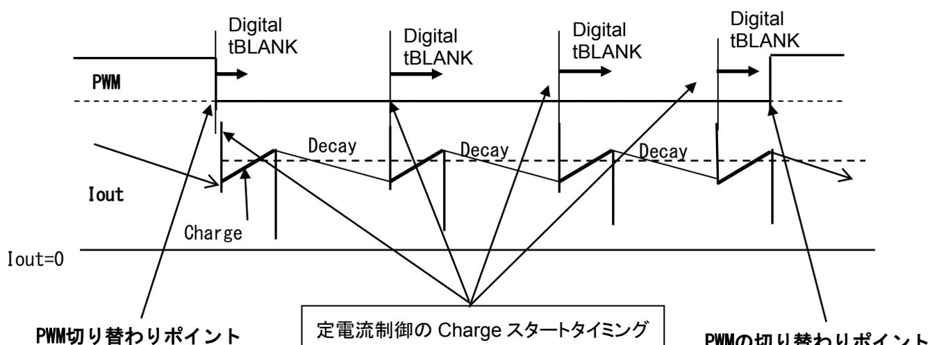
外部から入力される PWM 信号(CLK\_X、ENABLE\_X)の切り替え直後(ショートブレーキからチャージのタイミングなど)、および定電流チョップ時の Charge 開始タイミングにデジタルの「tBLANK」が入ります。
