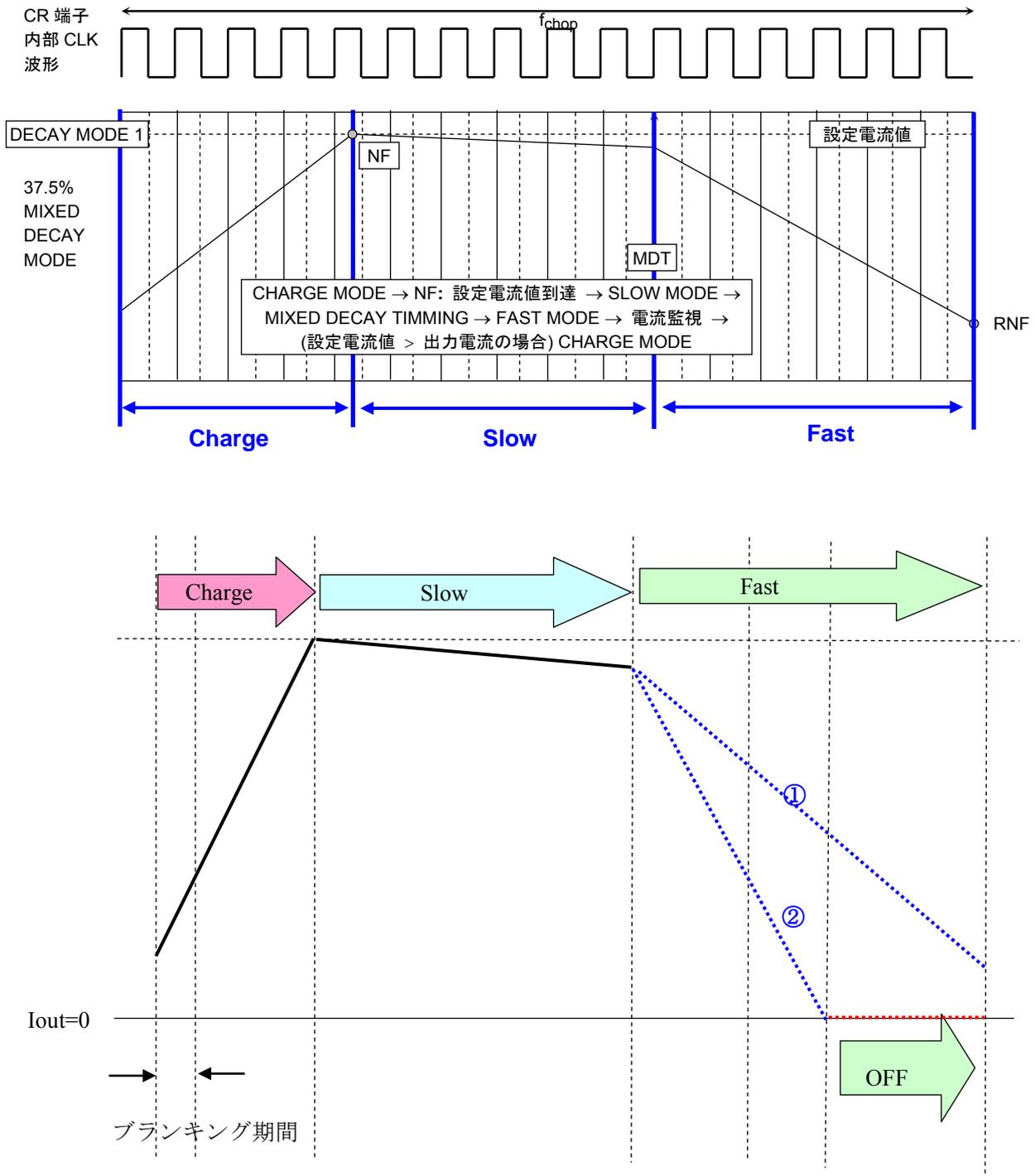
[NF]は出力電流が設定電流値に到達したポイントを示します。[Charge]時間は、励磁相の特性(インダクタンス/抵抗など)で異なる値を示します。
