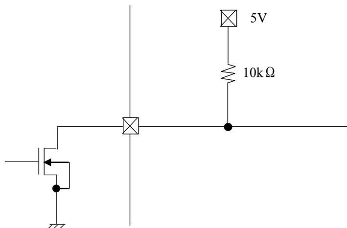
Open Drain の出力になります。出力端子を抵抗で電源に Pull Up した場合、Reset 時には Low を出力(内部 ON)、通常の動作時(非 Reset 時)は、High(内部 Hi-Z)が出力されます。
