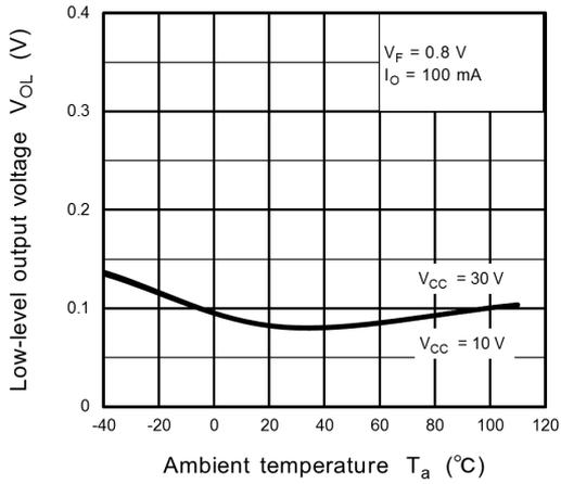
Fig. 13.2.7  $V_{OL} - T_a$
