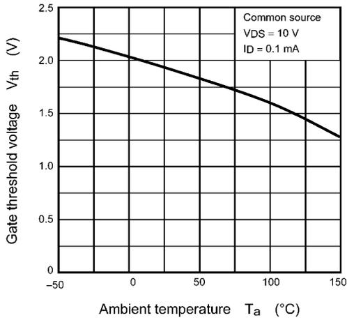
**Fig. 9.7**  $V_{th} - T_a$
