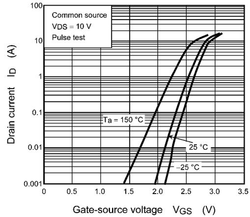
**Fig. 9.2  $I_D - V_{GS}$**
