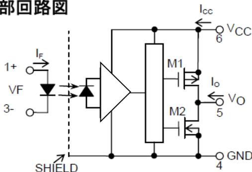
注: 6ピンと4ピンの間にバイパス用のコンデンサ 0.1 μF を付ける必要があります。バイパス用のコンデンサはカプラから 1cm 以内に付けてください。
