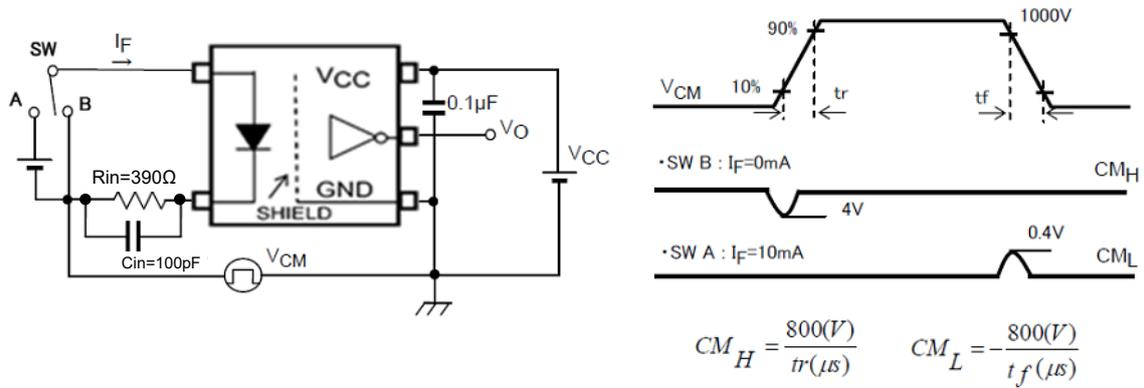
図4 コモンモード過渡耐性測定回路、波形
