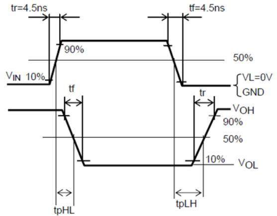
图 2 tpHL、tpLH 测定回路、波形
