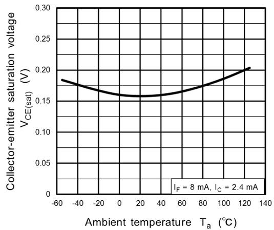
**Fig. 11.10  $V_{CE(sat)} - T_a$**
