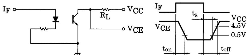
図 10.1 スイッチング時間測定回路, 波形
