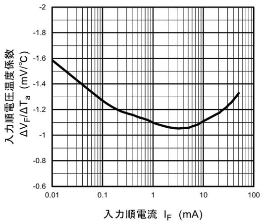
図 11.5  $\Delta V_F / \Delta T_a - I_F$
