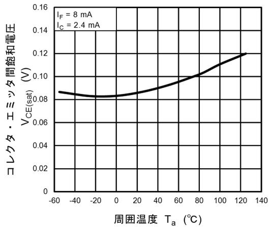
図 11.10  $V_{CE(sat)} - T_a$
