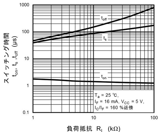
図 11.14 スイッチング時間 -  $R_L$
