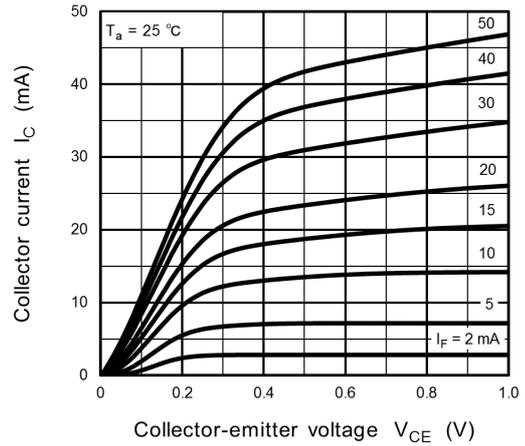
**Fig. 11.8  $I_C - V_{CE}$**
