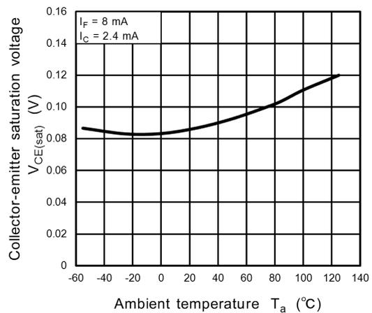
**Fig. 11.10  $V_{CE(sat)} - T_a$**
