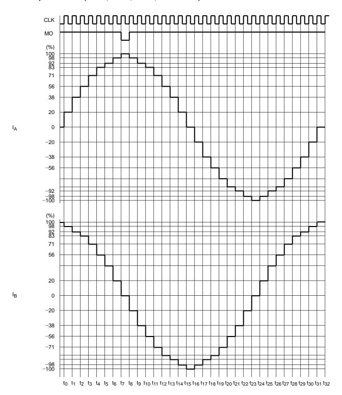
1/16-step resolution (M1: H, M2: H, M3: L, CW Mode)
