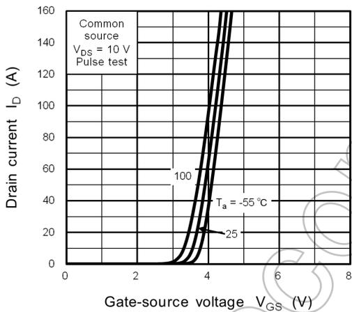
Fig. 9.3  $I_D - V_{GS}$
