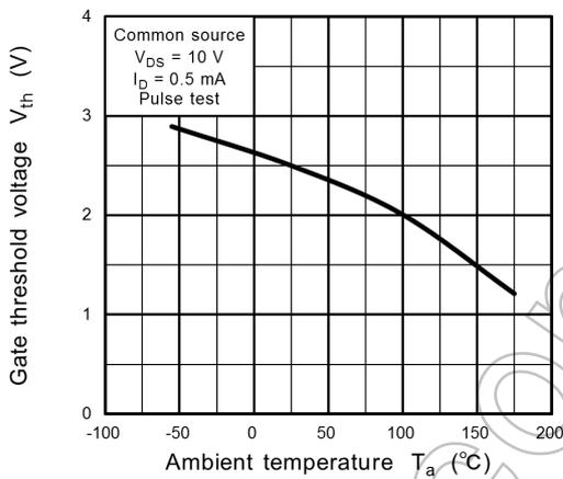
Fig. 9.9  $V_{th} - T_a$
