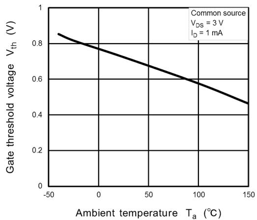
**Fig. 9.1.6**  $V_{th} - T_a$
