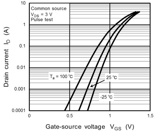
**Fig. 9.1.2**  $I_D - V_{GS}$
