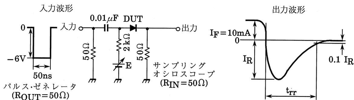
図 1. 逆回復時間 ( $t_{rr}$ ) 測定回路
