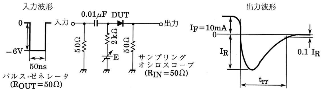
図 1. 逆回復時間 (t<sub>rr</sub>) 測定回路
