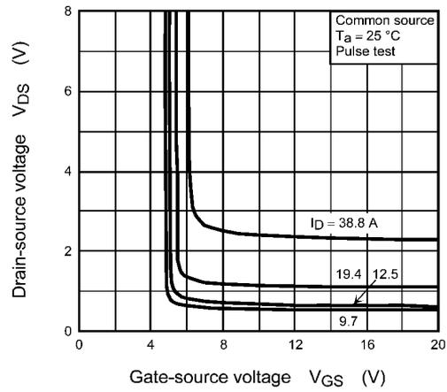
Fig. 8.4  $V_{DS} - V_{GS}$
