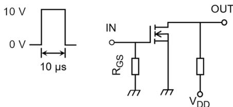
Fig. 6.3.1 Switching Time Test Circuit
