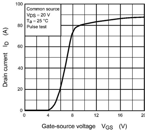
**Fig. 8.3  $I_D - V_{GS}$**
