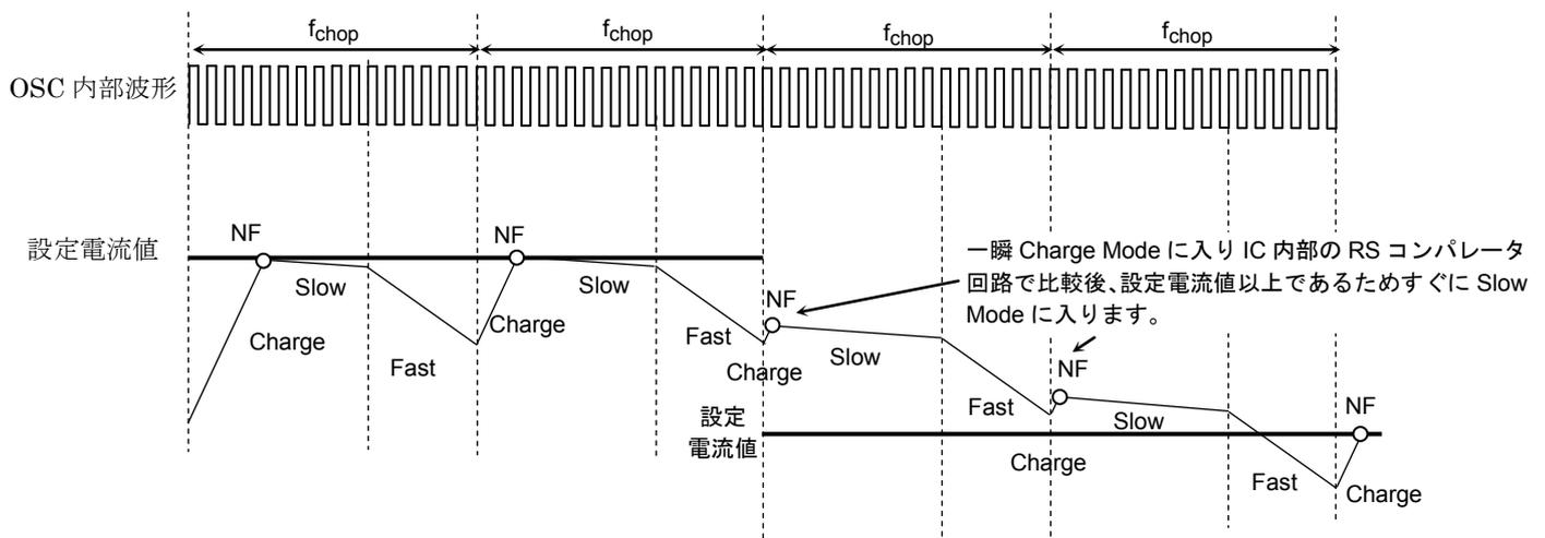
Charge の開始と同時に OSCM 端子内部 CLK のカウンタがスタートし、出力電流値が設定値へ達すると RS コンパレータ回路で設定電流値を検出 (NF)して Slow Decay Mode へ入ります。
