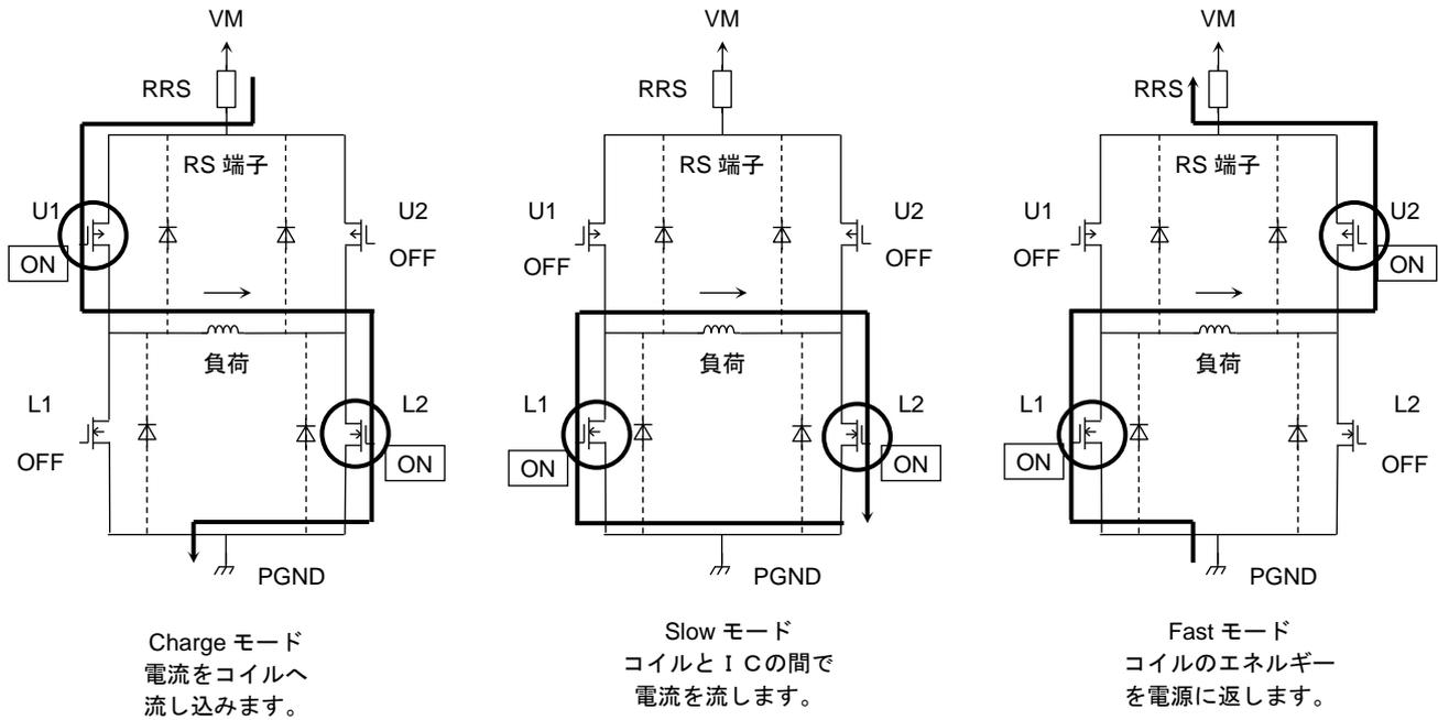
図 6.10 出力段トランジスタ動作モード
