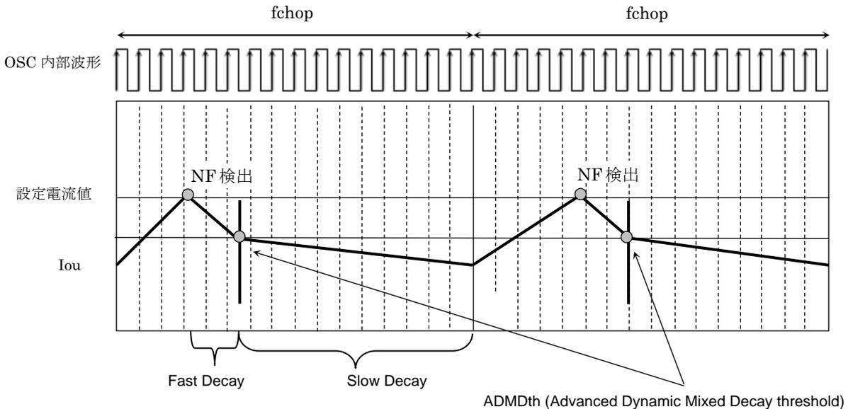
図 6.5 Auto Decay Mode の波形 (電流波形)
