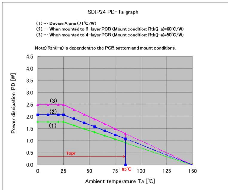
図 7 PD - Ta (パッケージの許容損失)
