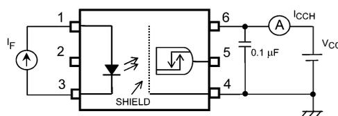
図 13.1.4 ICCH測定回路
