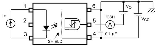
図 13.1.6 IOSH測定回路
