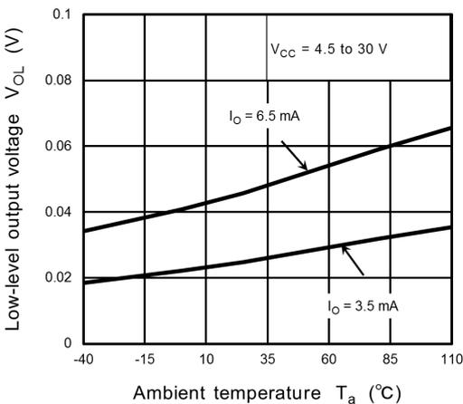
**Fig. 13.2.5  $V_{OL} - T_a$**
