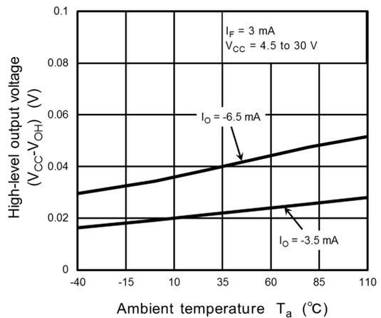
**Fig. 13.2.6  $(V_{CC} - V_{OH}) - T_a$**
