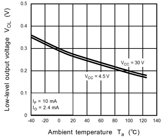
Fig. 13.2.8  $V_{OL} - T_a$
