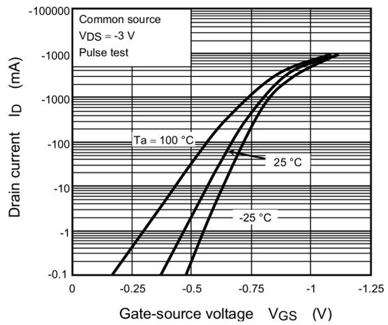
Fig. 7.2  $I_D - V_{GS}$
