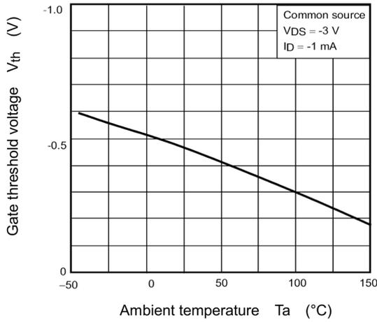
**Fig. 7.7  $V_{th} - T_a$**
