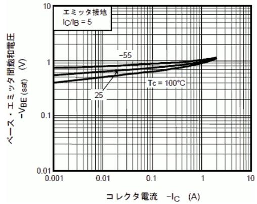
図 8.4  $V_{BE(sat)} - I_C$
