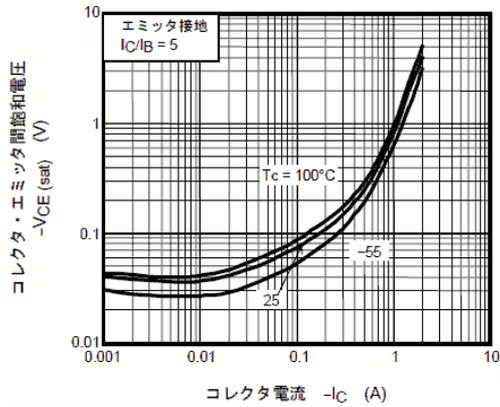
図 8.3  $V_{CE(sat)} - I_C$
