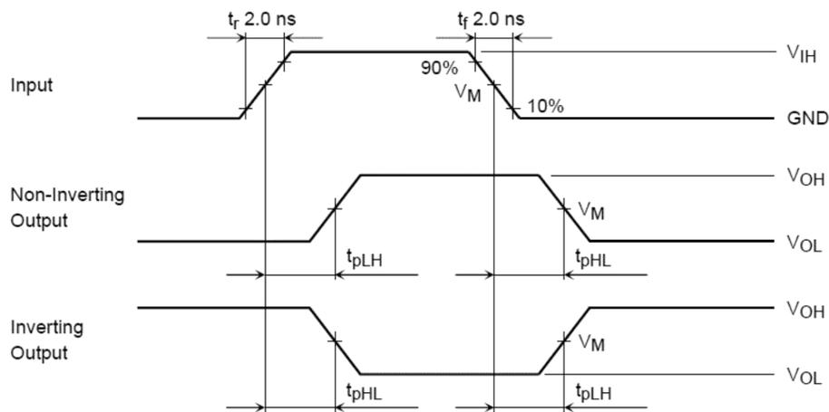
Fig. 12.8.1  $t_{pLH}$ ,  $t_{pHL}$
