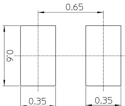
**図 7.1 参考パッド寸法 (Unit: mm)**
