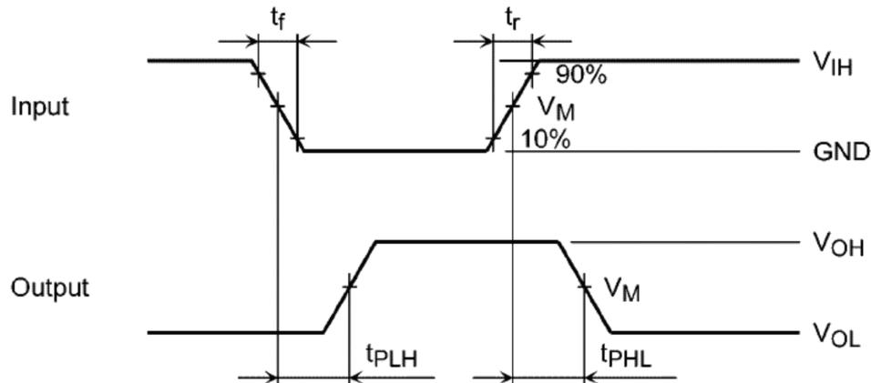
図 12.8.1  $t_{PLH}$ ,  $t_{PHL}$
