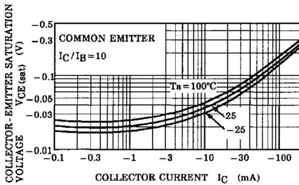
Fig. 8.3  $V_{CE(sat)} - I_C$
