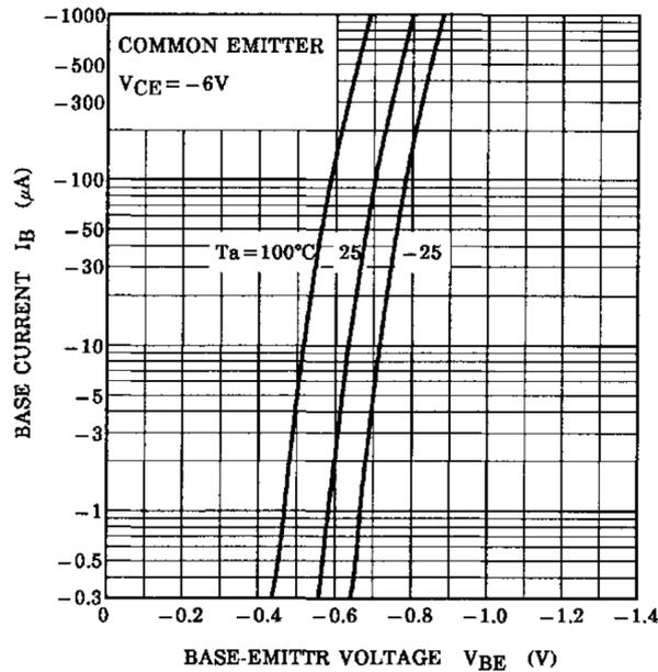
Fig. 8.6  $I_B - V_{BE}$
