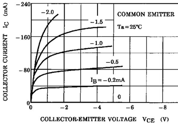
Fig. 8.1  $I_C - V_{CE}$
