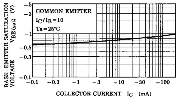
Fig. 8.4  $V_{BE(sat)} - I_C$
