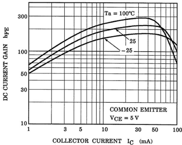
Fig. 10.7 RN1907FE  $h_{FE}$ - $I_C$
