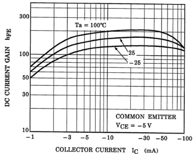
Fig. 10.18 RN2906FE  $h_{FE}$ - $I_C$
