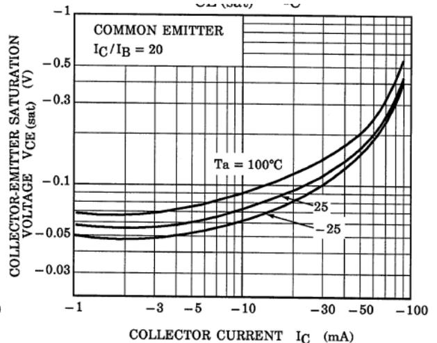
Fig. 10.24 RN2906FE  $V_{CE(sat)}$ - $I_C$
