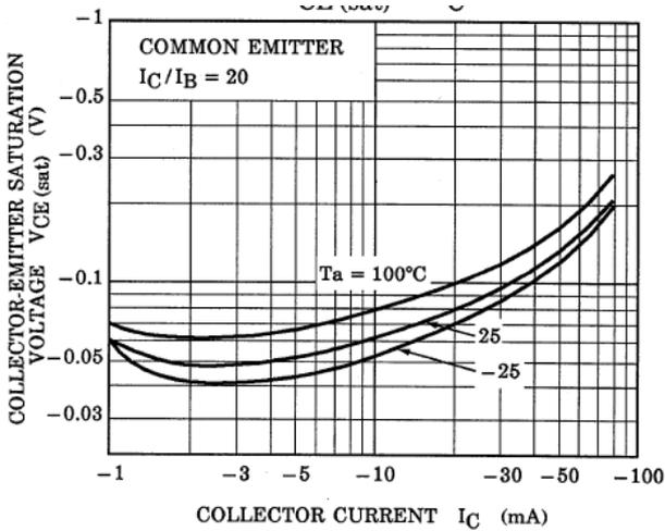
Fig. 10.21 RN2903FE  $V_{CE(sat)}$ - $I_C$
