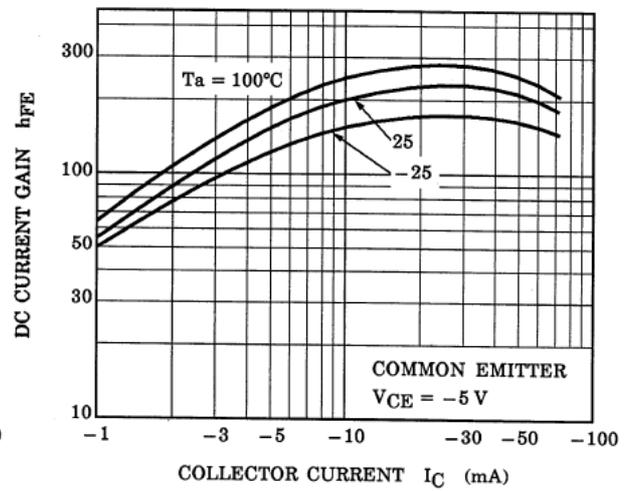
Fig. 10.16 RN2904FE  $h_{FE}$ - $I_C$
