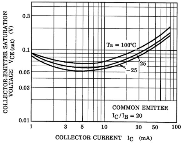
Fig. 14.7 Q1  $V_{CE(sat)}-I_C$
