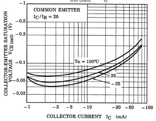
Fig. 14.8 Q2  $V_{CE(sat)}-I_C$
