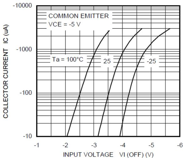
Fig. 10.10 RN2418  $I_C$ - $V_{I(OFF)}$
