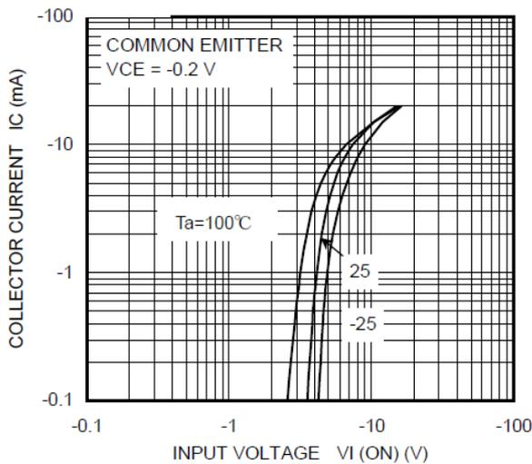
Fig. 10.5 RN2418  $I_C$ - $V_{I(ON)}$
