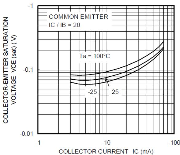
Fig. 10.20 RN2418  $V_{CE(sat)}-I_C$
