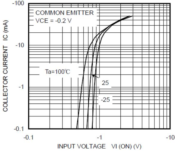
Fig. 10.1 RN2414  $I_C$ - $V_{I(ON)}$
