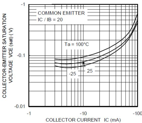
Fig. 10.18 RN2416  $V_{CE(sat)}-I_C$
