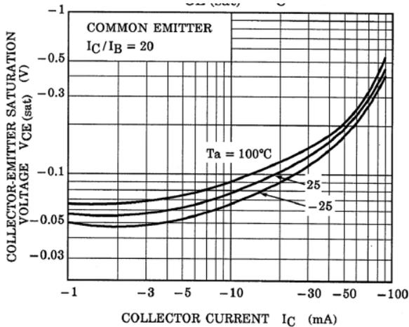
Fig. 10.23 RN2405  $V_{CE(sat)}$ - $I_C$
