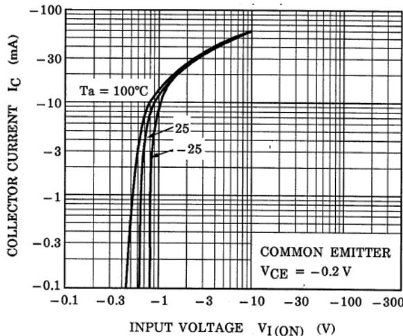
Fig. 10.5 RN2405  $I_C$ - $V_{I(ON)}$
