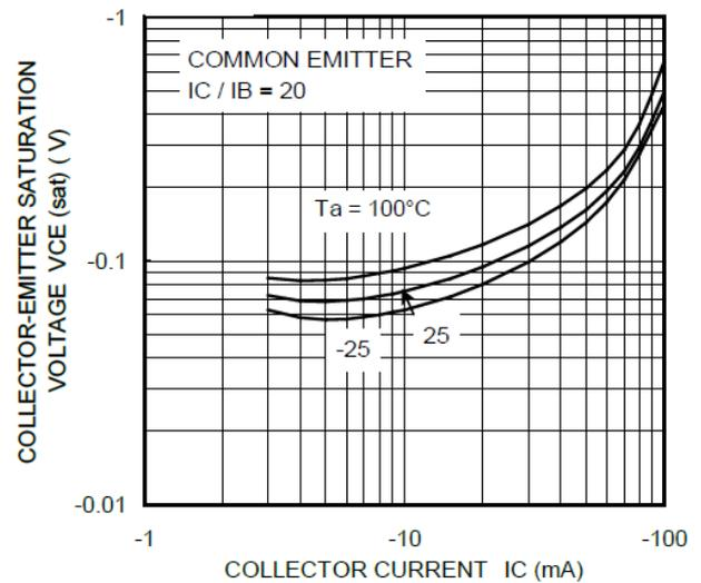
Fig. 10.18 RN2316  $V_{CE(sat)}-I_C$
