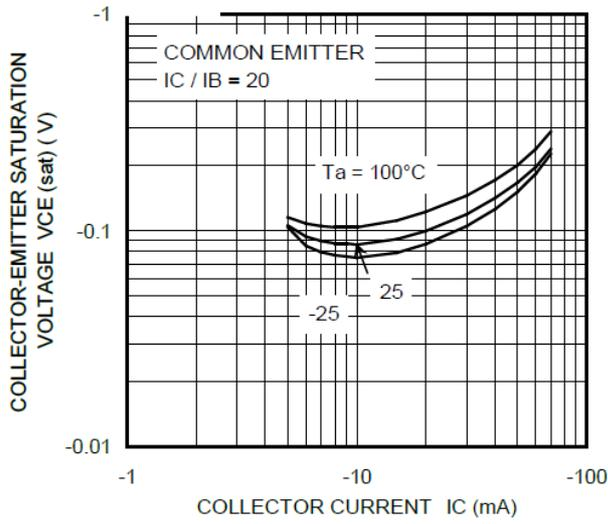
Fig. 10.19 RN2317  $V_{CE(sat)}-I_C$
