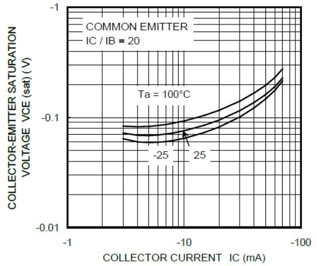
Fig. 10.20 RN2318  $V_{CE(sat)}-I_C$
