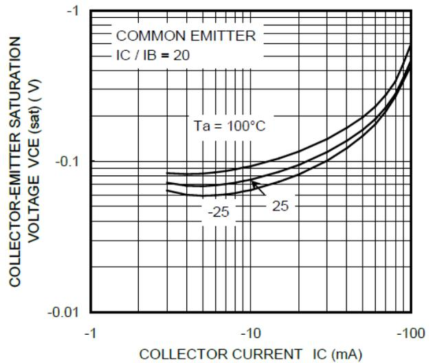
Fig. 10.16 RN2314  $V_{CE(sat)}-I_C$
