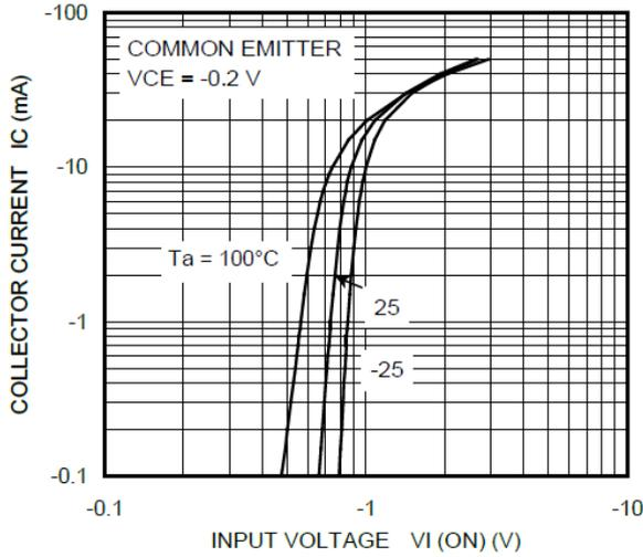
Fig. 10.1 RN2314  $I_C$ - $V_{I(ON)}$
