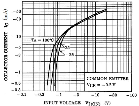
Fig. 9.2 RN2311  $I_C$ - $V_{I(ON)}$
