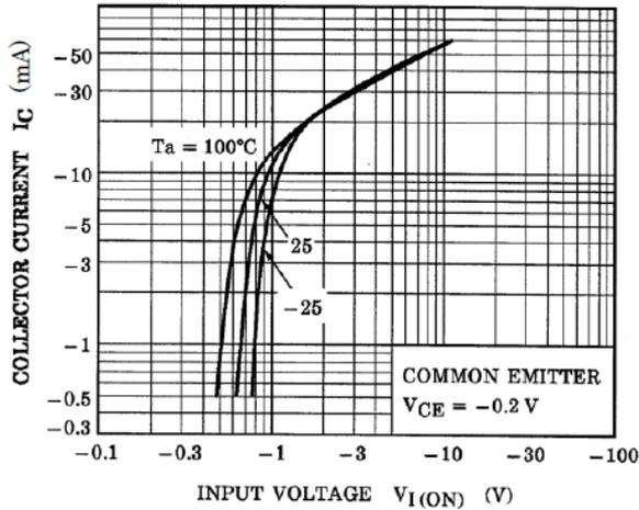
Fig. 9.1 RN2310  $I_C$ - $V_{I(ON)}$
