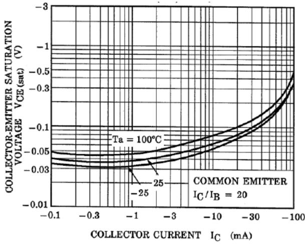
Fig. 9.7 RN2310  $V_{CE(sat)}$ - $I_C$
