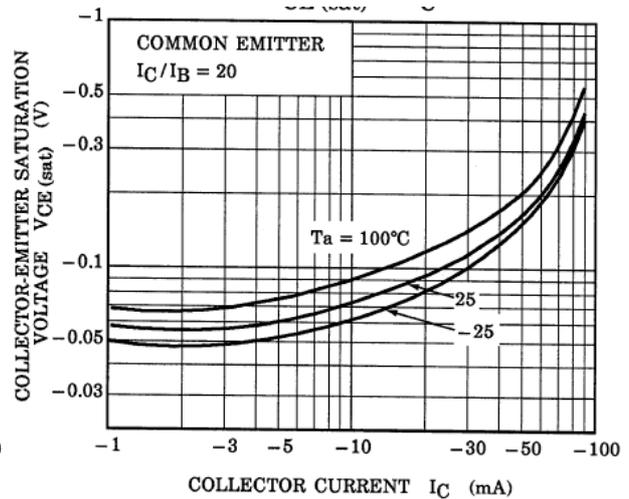
Fig. 10.24 RN2106  $V_{CE(sat)}-I_C$
