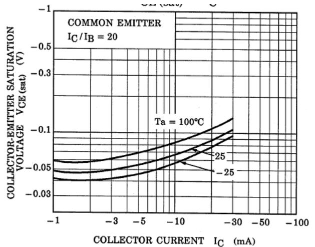
Fig. 10.22 RN2104  $V_{CE(sat)}-I_C$
