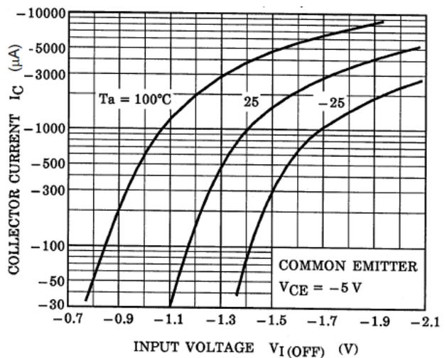
Fig. 10.10 RN2104  $I_C$ - $V_{I(OFF)}$
