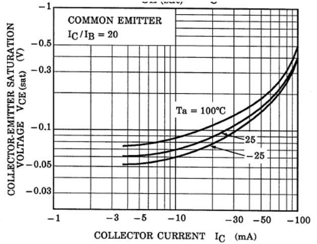
Fig. 10.20 RN2102  $V_{CE(sat)}-I_C$
