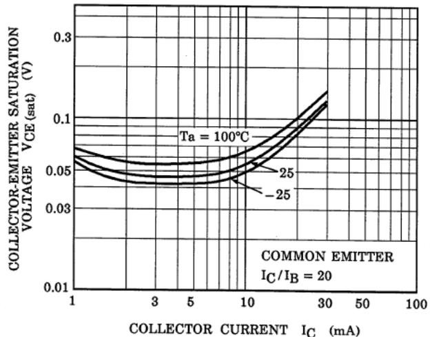
Fig. 10.12 RN1409  $V_{CE(sat)}$ - $I_C$
