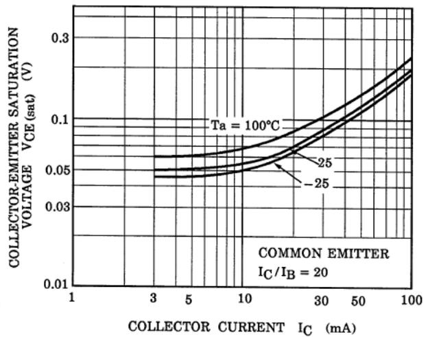
Fig. 10.10 RN1407  $V_{CE(sat)}$ - $I_C$
