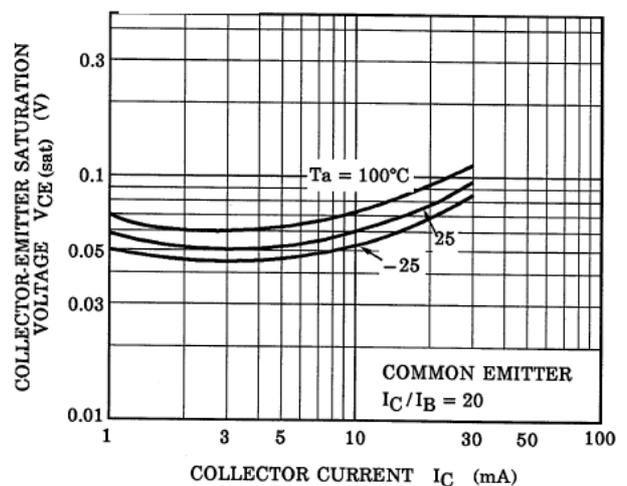
Fig. 10.22 RN1404  $V_{CE(sat)}-I_C$
