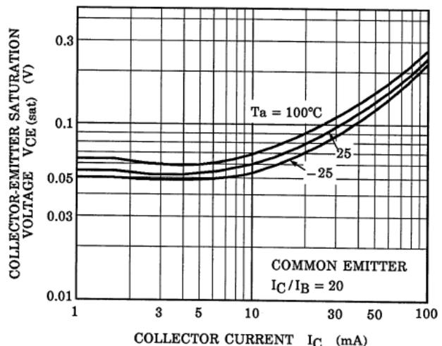
Fig. 10.24 RN1406  $V_{CE(sat)}-I_C$
