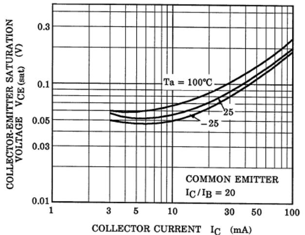
Fig. 10.20 RN1402  $V_{CE(sat)}-I_C$
