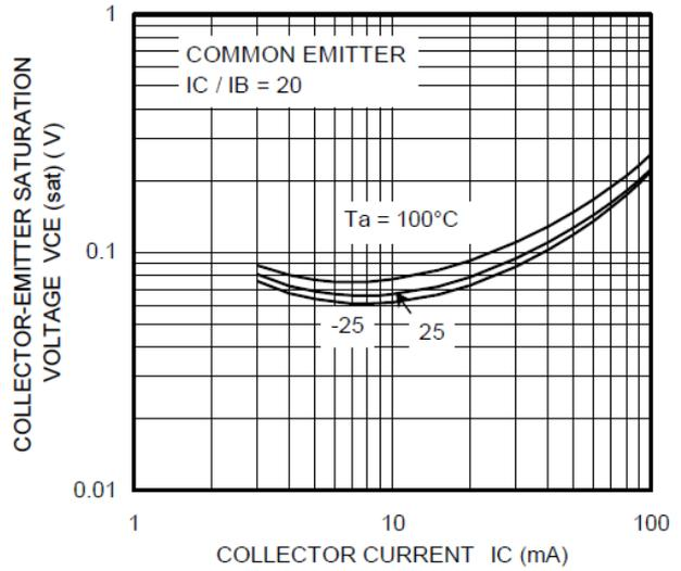
**Fig. 10.17 RN1115  $V_{CE(sat)}$ - $I_C$**
