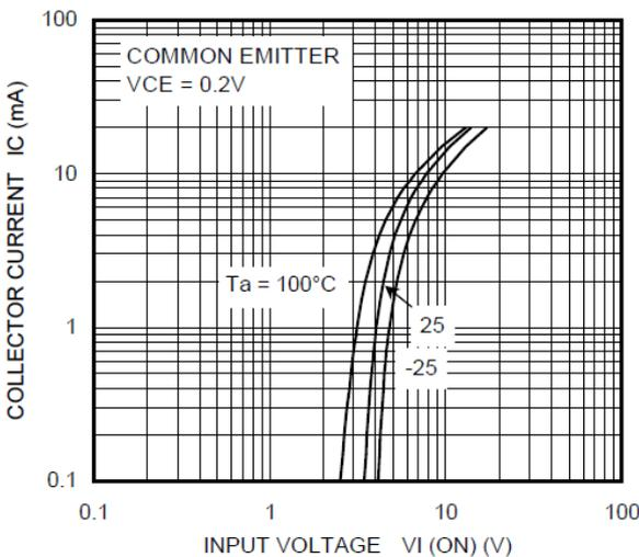
Fig. 10.5 RN1118  $I_C$ - $V_{I(ON)}$
