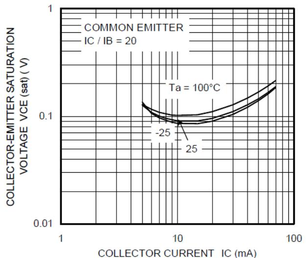
**Fig. 10.19 RN1117  $V_{CE(sat)}$ - $I_C$**
