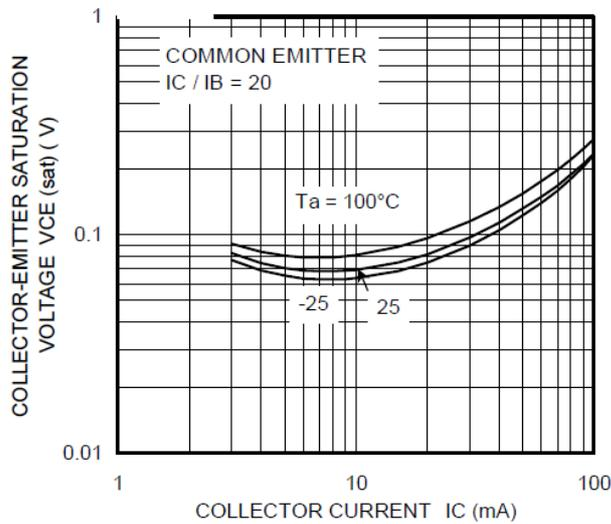
**Fig. 10.18 RN1116  $V_{CE(sat)}$ - $I_C$**
