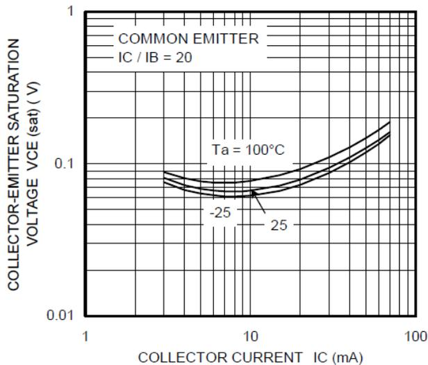
**Fig. 10.20 RN1118  $V_{CE(sat)}$ - $I_C$**
