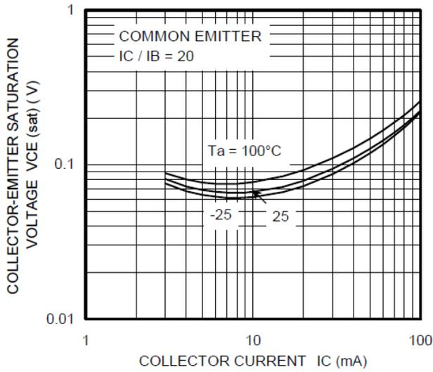
**Fig. 10.16 RN1114  $V_{CE(sat)}$ - $I_C$**
