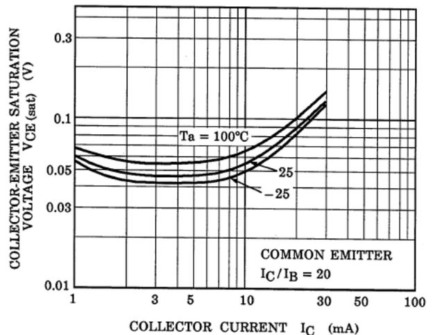
Fig. 10.12 RN1109  $V_{CE(sat)}-I_C$
