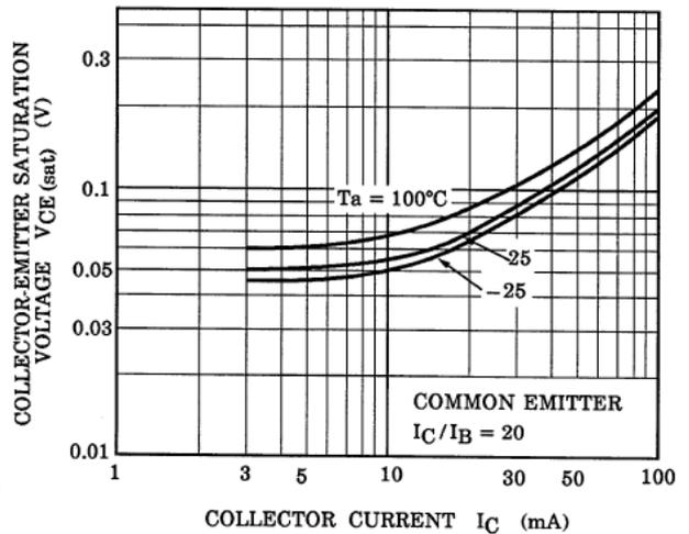
Fig. 10.10 RN1107  $V_{CE(sat)}-I_C$
