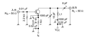
L1:  $\phi$ 0.8 mm の銀メッキ銅線, 4 ターン, 10 mm 内径, 8 mm 長
