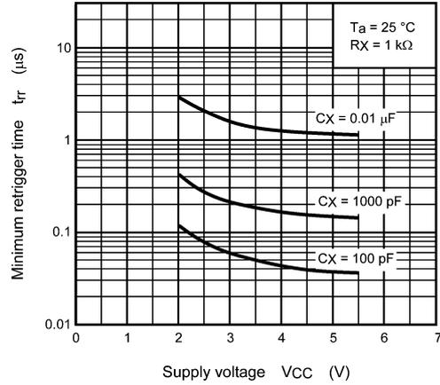
**Fig. 15.2  $t_r$  -  $V_{CC}$  (typ.)
