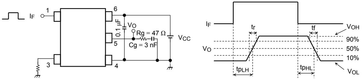
図 8 コモンモード過渡耐性測定回路、波形
