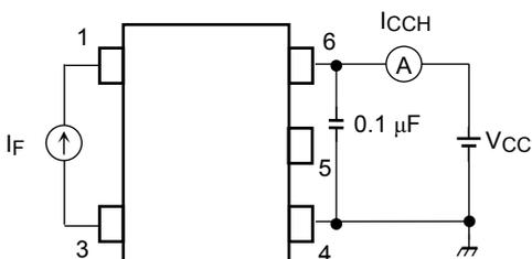
図 6. I<sub>cCL</sub> 測定回路
