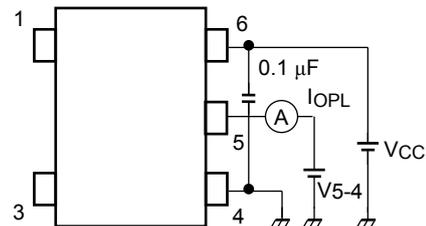
図 3. V<sub>OH</sub> 測定回路
