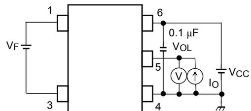
図 5. I<sub>cCH</sub> 測定回路
